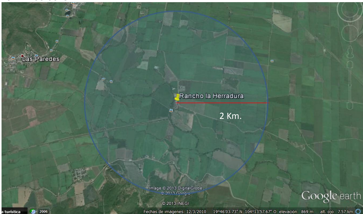
Figura 7. Radio de Alcance de medición de la Unidad Móvil de Monitoreo Atmosférico
